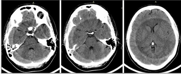
Esta serie de imágenes de TC muestra artefactos anulares reales. Los anillos aparecen en un espectro uniforme en cada posición angular. Esto suele ocurrir cuando un detector no está calibrado.
